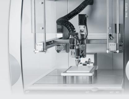
Palettieren, Einsetzen, Umsetzen, Schrauben, Dispensen, Testen, Prüfen, Löten, Greifen, Öffnen, Schließen von Gefäßen und vieles mehr: Das kleinbauende IFC-Handlingsystem ist die Basis für verschiedenste Desktop-Anwendungen.
