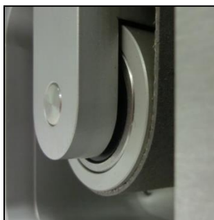
Einstellung über einlaufseitige Einstellschrauben
