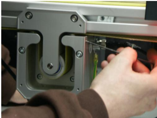
Spannen Sie den Riemen durch gleichmäßiges Eindrehen der jeweiligen Feststellschrauben-Paare am Motorblock.
