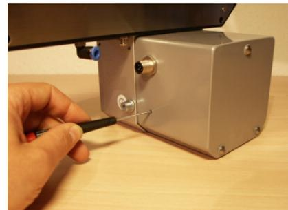
Es ist darauf zu achten, daß das Potentiometer nicht zu weit nach links gedreht wird, sonst bleibt der Motor stehen (Drehzahl <10%).
